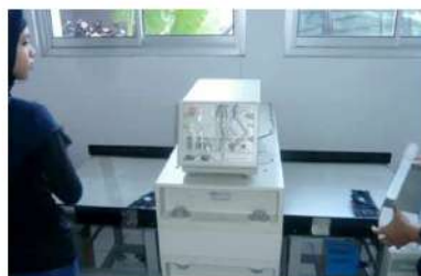
検針器による検査
