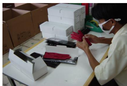
写真13: 梱包後抜き取り検査
